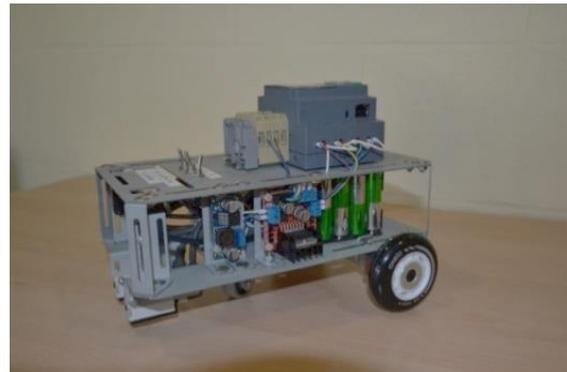
Le robot INVENTUS au départ d'une carte ARDUINO, le montage d'un robot suiveur de ligne : précision, vitesse, labyrinthe, détection d'obstacles.
