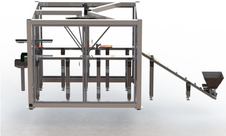
Nouvelles technologies telles que Robot Delta 3 full inox, Vision active, Synchronisation d'axes, Bus Ethernet Real Time, E/S déportées...
